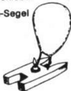
Aufsteigende Wärme wirkt auf das besonders geformte Wärme-segel aus Stanniol.
